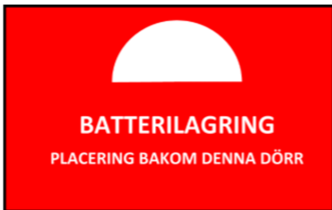
Figur 4 Exempel på skyltning av batterilager.
